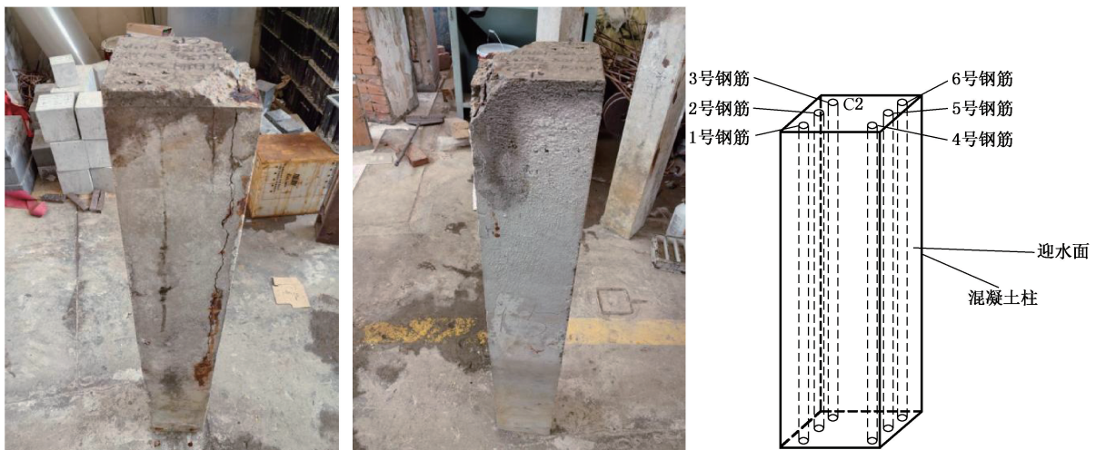
图 A.2 混凝土试件 C2 锈蚀形态
